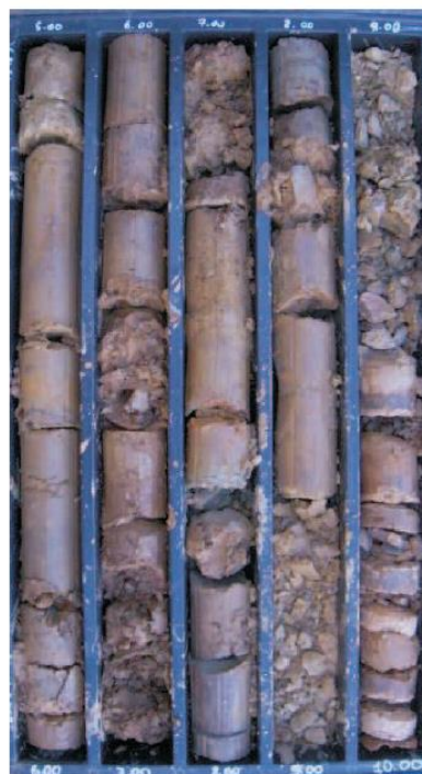
Fig. 3.5/E: restituzione fotografica della stratigrafia del sondaggio L072
