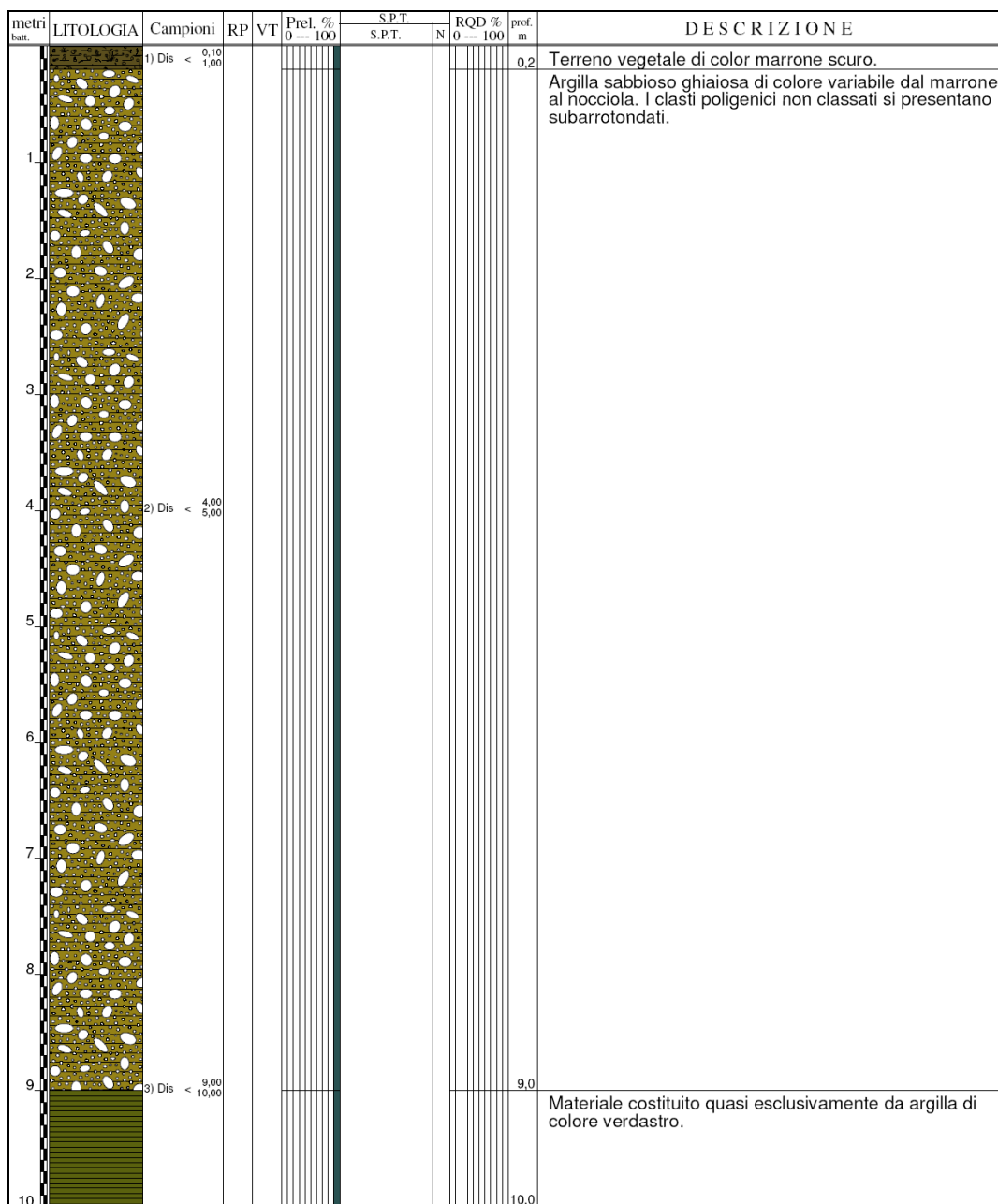
Fig. 3.5/G: stratigrafia del sondaggio L073
