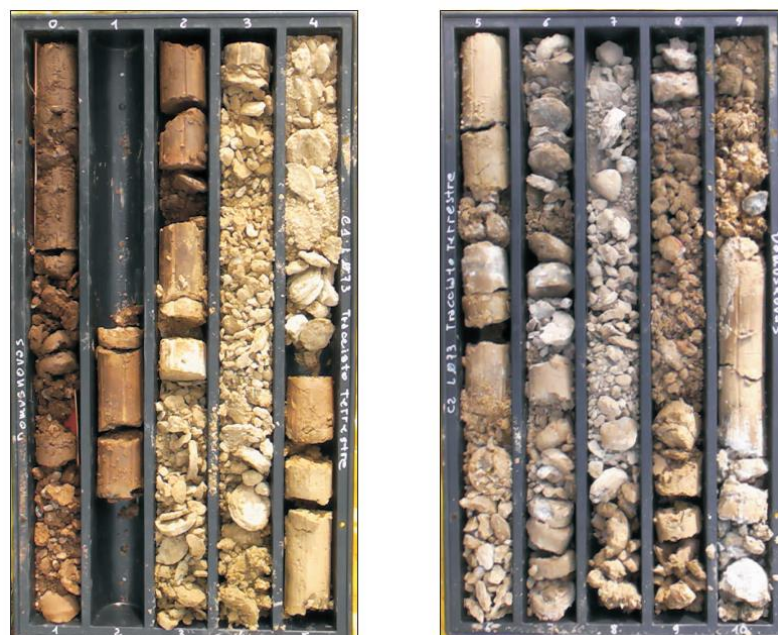
Fig. 3.5/H: restituzione fotografica della stratigrafia del sondaggio L072
