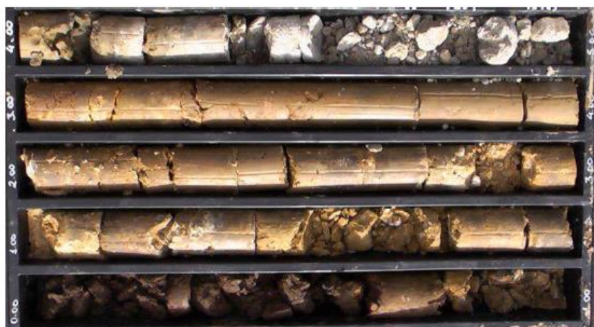
Fig. 4/C: restituzione fotografica della stratigrafia del sondaggio L071
