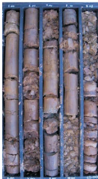
Fig. 4/E: restituzione fotografica della stratigrafia del sondaggio L072
