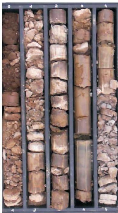
Fig. 4/E: restituzione fotografica della stratigrafia del sondaggio L072
