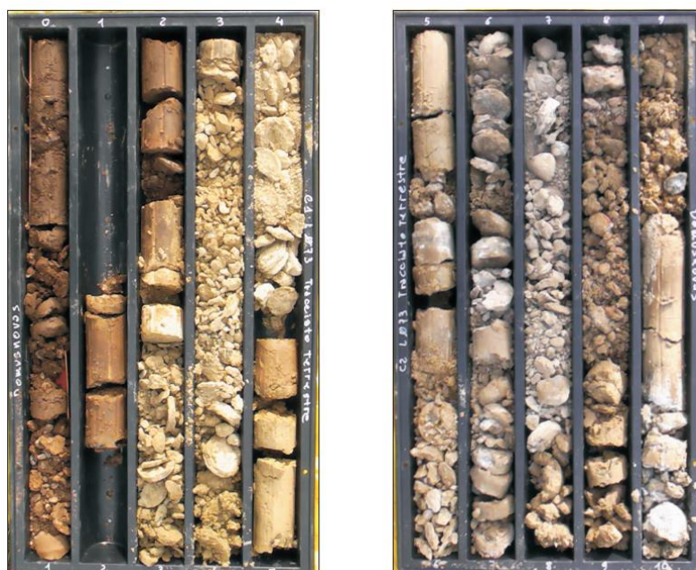
Fig. 4/H: restituzione fotografica della stratigrafia del sondaggio L072
